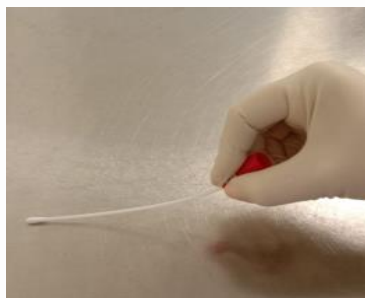
Рисунок 2. Расположение тампона (сваба) при выполнении смыва.
