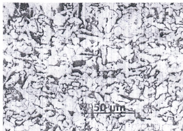
Рисунок 6. Микроструктура стали вне ЗТВ на расстоянии 10 мм от центра, 500 ×
