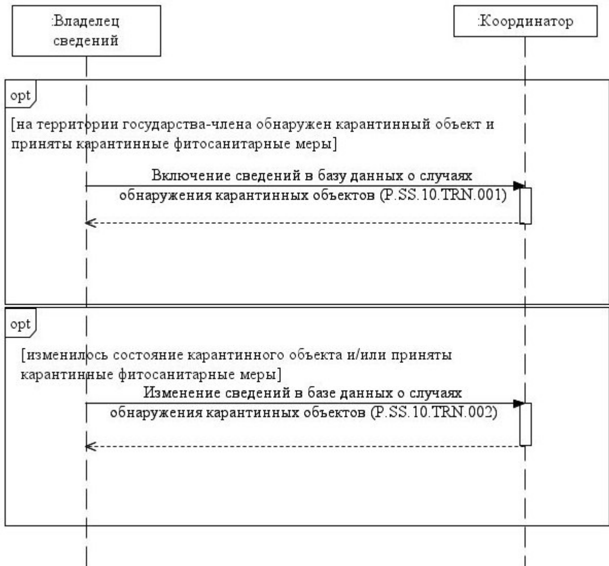
Рис. 2. Схема выполнения транзакций общего процесса при формировании и ведении базы данных о случаях обнаружения карантинных объектов
