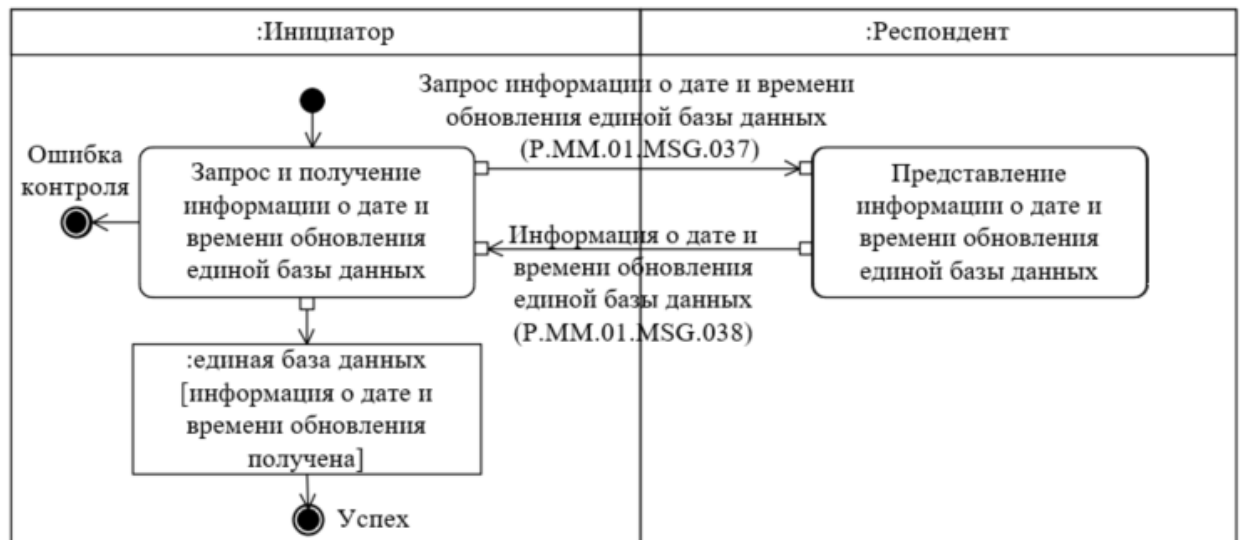
Рис.21. Схема выполнения транзакции общего процесса «Получение информации о дате и времени обновления единой базы данных» (P.MM.01.TRN.027)
