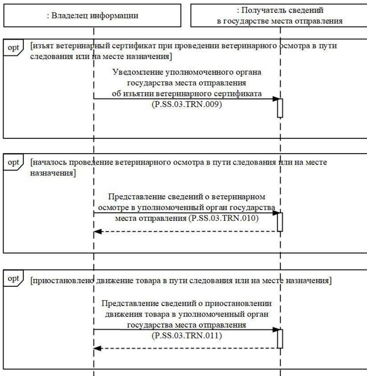
Рис. 5. Схема выполнения транзакций общего процесса при представлении сведений при проведении ветеринарного осмотра в пути следования и на месте назначения в уполномоченный орган государства места отправления
