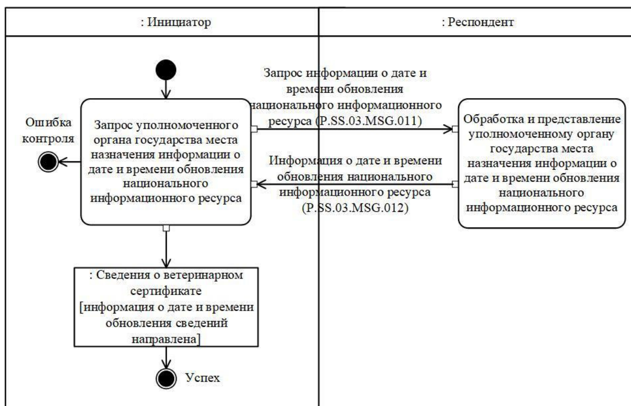
Рис. 27. Схема выполнения транзакции общего процесса «Представление уполномоченному органу государства места назначения информации о дате и времени обновления национального информационного ресурса» (P.SS.03.TRN.018)
